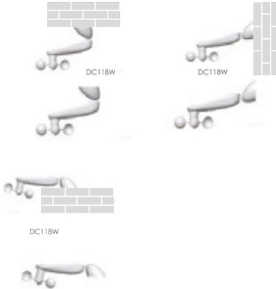
Es ist möglich die Installationsseite zu verändern. Hierzu müssen Sie die Stromzufuhrbox öffnen, die Verschraubungen lösen, die gewünschte Installationsseite einstellen und anschließend die Schrauben fest anziehen.
