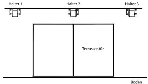
Installieren Sie eine Wandhalterung unter jedem Arm. Die Positionen sind an der Markisenrückseite mit Klebestreifen markiert. Durch die Montage der Halterungen unter den Armen erreichen Sie eine optimale Halterung der Markise.
