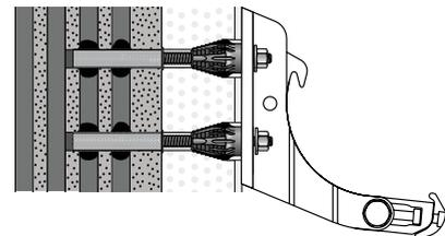
Für Aussenwände mit Wärmedämmverbundsystem empfehlen wir eine Befestigung der Markise mit fischer Thermax.
